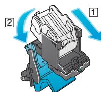
**8** Закройте крышку картриджа со скобами для брошюрования.
