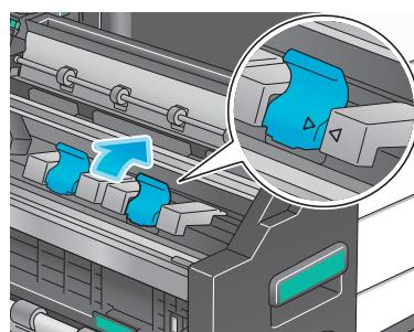
**11** Задвиньте устройство изготовлению брошюр.
