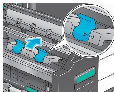
**11** Задвиньте устройство изготовлению брошюр.
