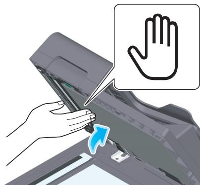
→ Нажмите на изображение руки в центре **открывающей и закрывающей направляющей** и проверьте, надежно ли зафиксировалась **открывающая и закрывающая направляющая**.
